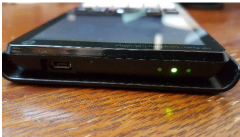
Figure 3 - clignotement unique de la diode verte en mode d'examen
